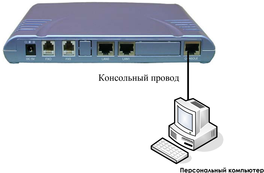
Рисунок 3-1: Соединение VoiceFinder AP200 и ПК для консольного управления
